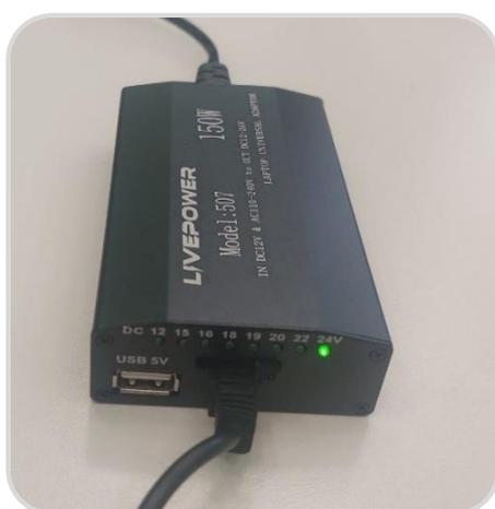
Убедитесь, что переключатель напряжения на блоке питания установлен в положение 24 В
