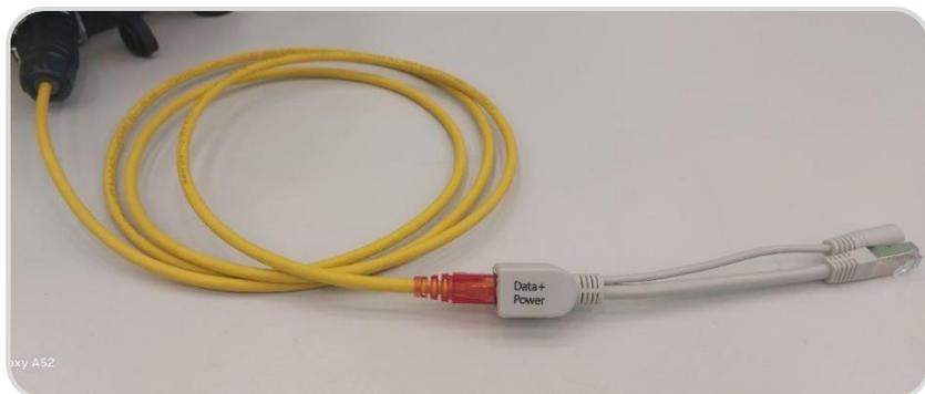
К противоположному концу кабеля присоедините PoE-инжектор, обеспечив плотный контакт соединения
