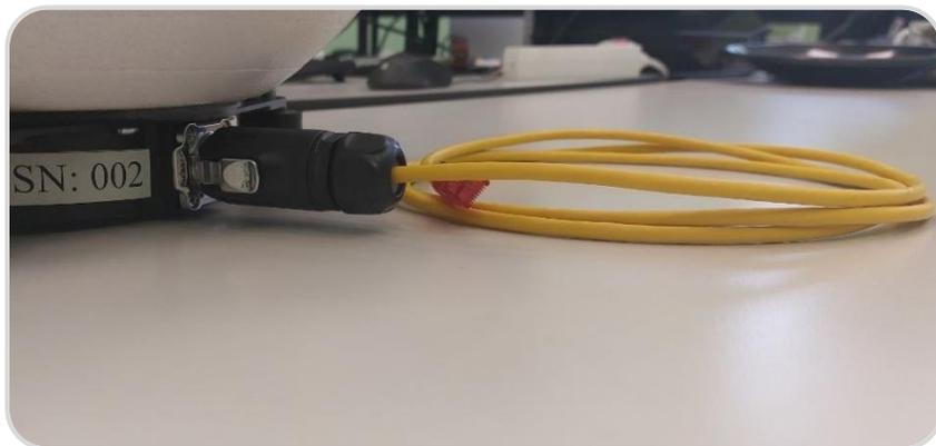
Подключите штатный кабель к соответствующему разъёму на корпусе терминала, соблюдая правильную ориентацию коннектора
