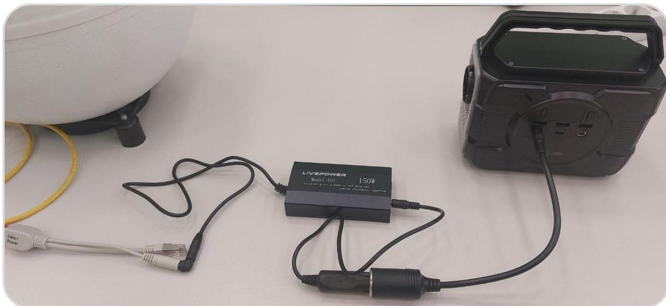
Для организации электропитания терминала от автономного источника выполните полную последовательность подключения, описанную в разделе «Подключение терминала к сети переменного тока 220 В / 50 Гц». На завершающем этапе используйте специальный адаптер для прикуривателя из комплекта поставки блока питания для соединения с розеткой прикуривателя автономного источника питания Cactus CS-PCS172
